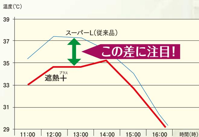
※愛知県田原市の農家様のハウス内で測定した遮熱性試験の実地データ温度センサーは地上から1mの位置で測定。(2015.9.11 測定)
